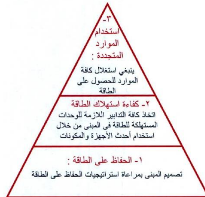
شكل 5 مثلث الطاقة لتصميم المباني منخفضة الطاقة. المصدر: [10]
